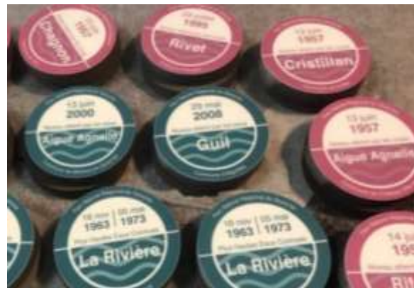
Échelle posée au pont du Peynin sur la commune d'Aiguilles et fabrication de repères en lave émaillée avec deux couleurs pour dissocier les niveaux atteints par les eaux au bord de cours d'eau (en bleu) et les niveaux atteints par les crues sur les cônes de déjection (en rose)
